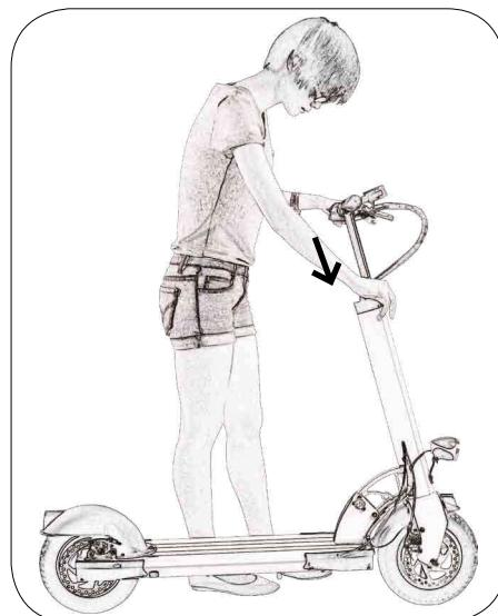
**Figyelmeztetés:** A BLUETOOTH e-roller egyedi összecsukó mechanizmussal rendelkezik, ami lehetővé teszi szállítás vagy tárolás esetén a gyors és könnyed kezelést.
